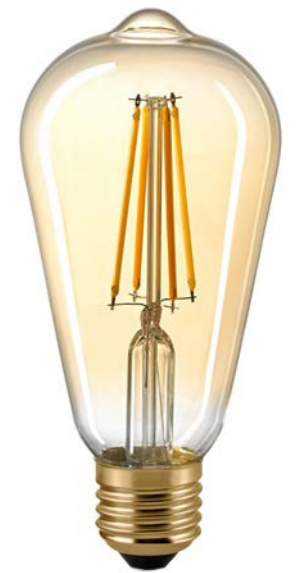
LM FILAMENT RUSTIKA 6136701 leuchtmittel, glas, gold bulb, glass, gold H 14 cm x Ø 6,4 cm 4,5 Watt, LED, 2500K, 420lm, E27
